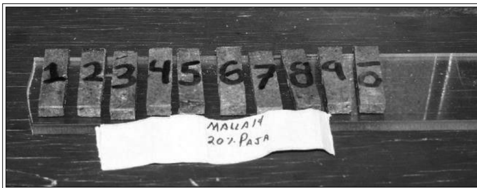
Figura 8. Probetas para las pruebas de impacto.
