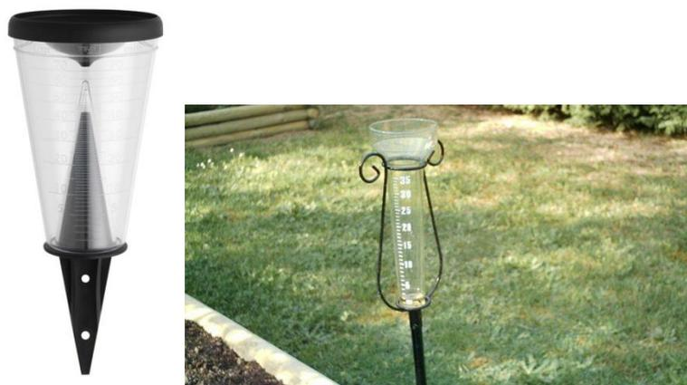
Figura 3 - Pluviómetros de uso común.
