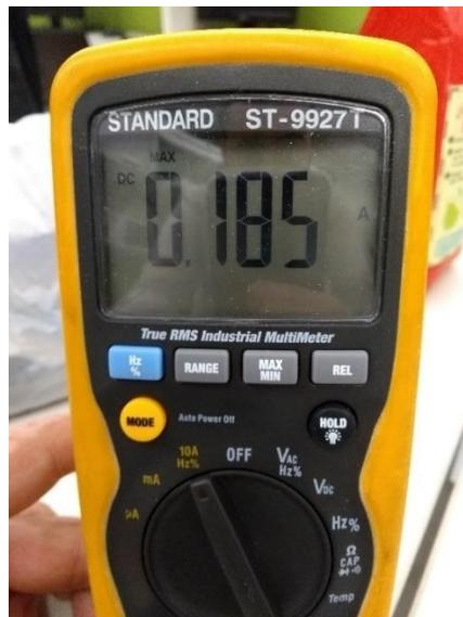
Figura 50 - Consumo de modulo RF con Tester.
