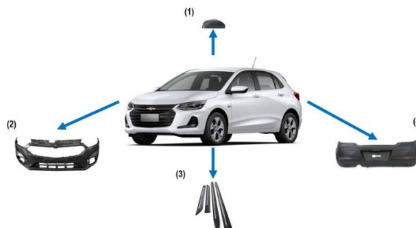
Figura 7: Representa las piezas inyectables del Chevrolet Ónix Fuente: Propia
