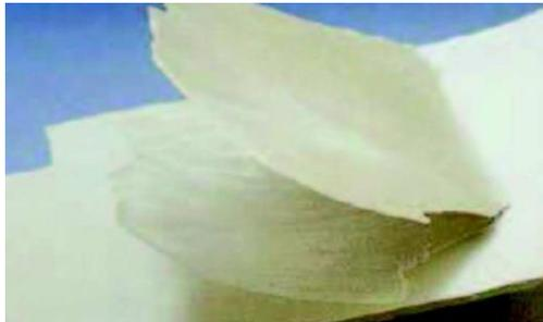
Figura 23: Fotografía que representa una delaminación - Fuente: [tecnologiadelosplasticos.blogspot.com](http://tecnologiadelosplasticos.blogspot.com)
