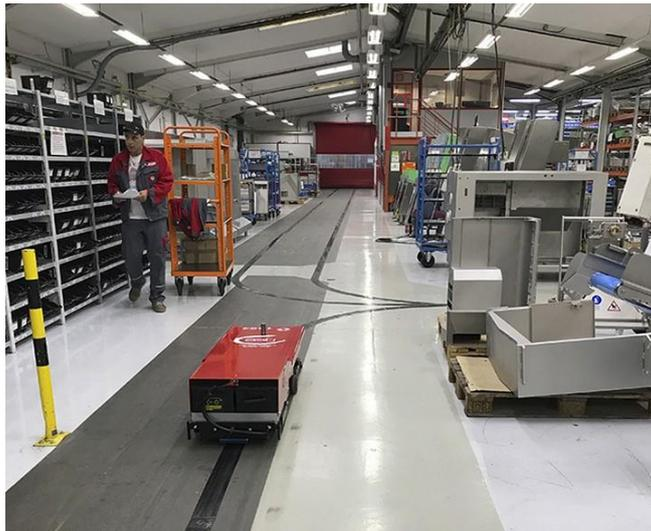
Figura 83: Imagen de AGV guiado por cinta magnética Fuente: ASTI
