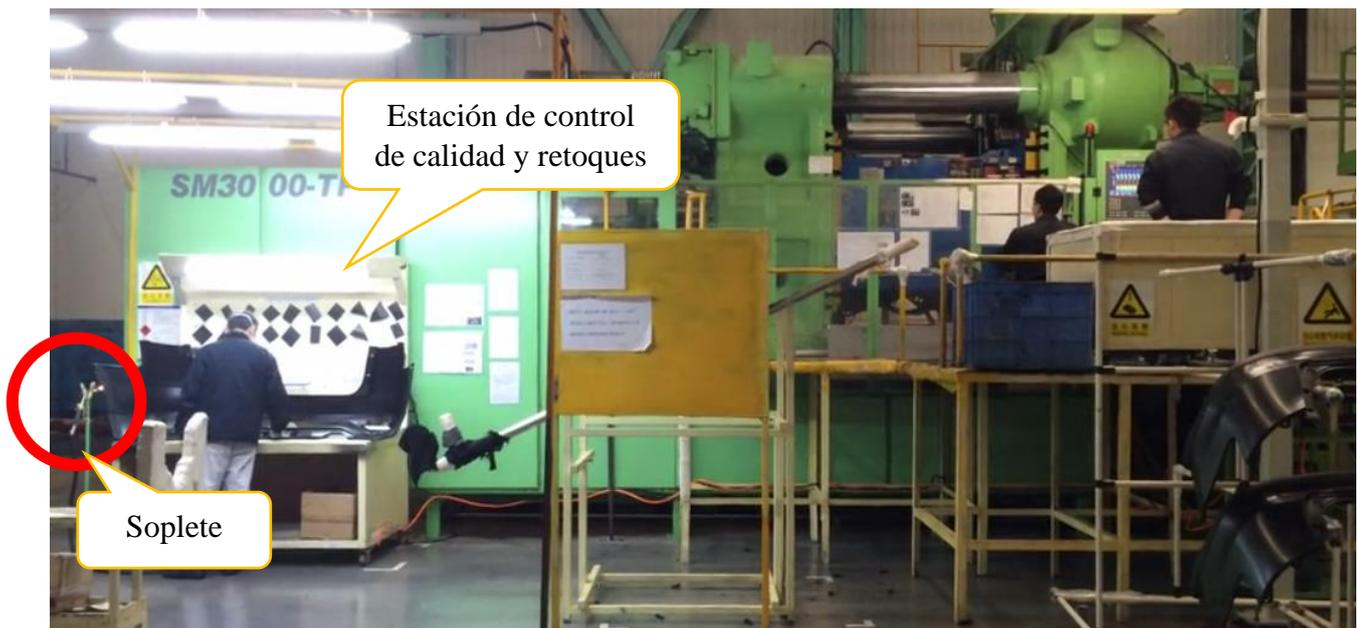
Figura 38: Fotografía de una planta inyectora y la estación de control de calidad a la izquierda Fuente: Chen Hsong
