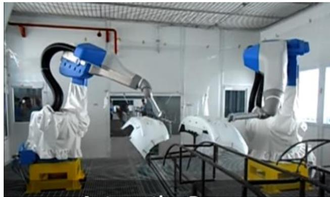
Figura 52: La imagen representa una cinta transportadora de paragolpes a través de una cabina de pintura automatizada Fuente: Motoman
