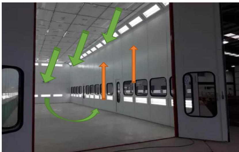
Figura 39: Esquematización del funcionamiento del sistema Venturi en una cabina de pintura base acuosa Fuente: Propia
