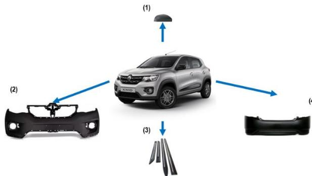
Figura 11: Representa las piezas inyectables del Renault Kwid Fuente: Propia
