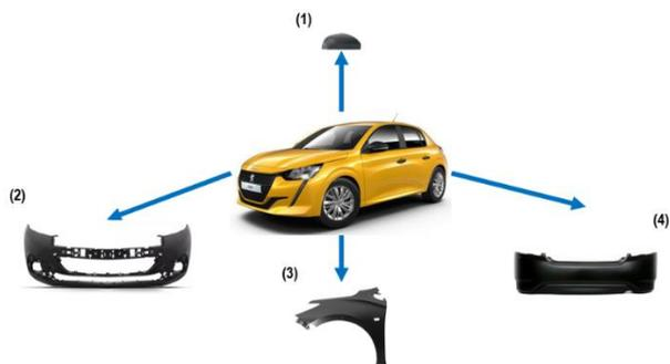
Figura 13: Representa las piezas inyectables del Peugeot 208 II Fuente: Propia
