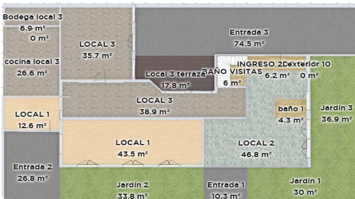
Figura N°23: Distribución proyectada de tres LOCALES COMERCIALES en primera planta de “Casona Infante” – Programa Home.by.me . Elaboración propia.
