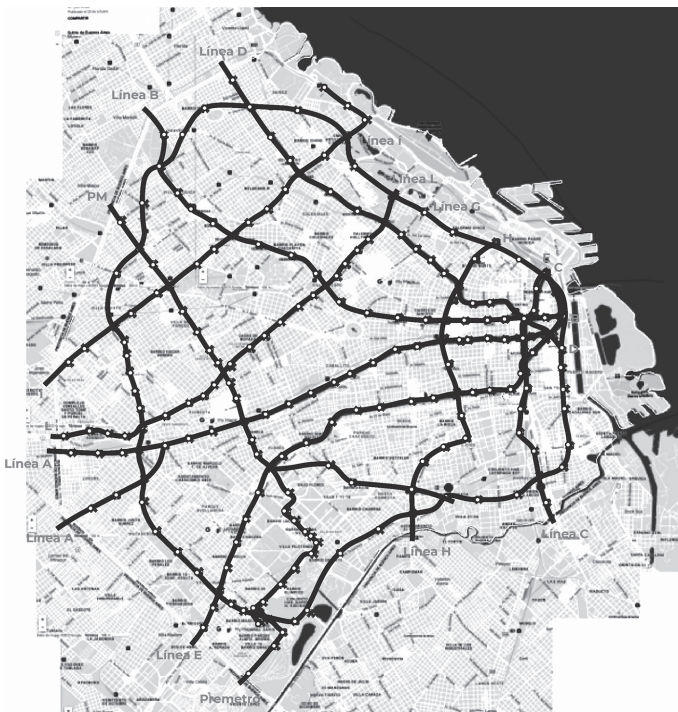
Figura 6. Resultado final de las líneas de metro optimizadas por el algoritmo.
