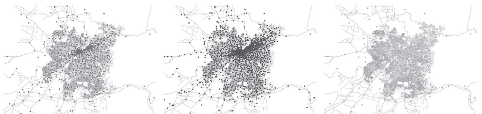
Figura 3. Distribución de antenas para Telefonía e Internet Móvil en la Región Metropolitana (SUBTEL, 2021). A la Izquierda se aprecia la distribución de frecuencias GSM 850; Al centro GSM 1900; A la Derecha LTE 700.
