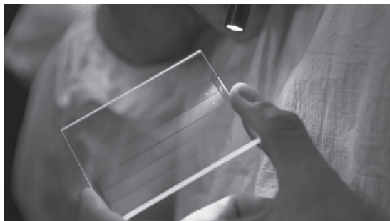
Figura 15. Imagen de disco duro compuesto por cristal de sílice. Proyecto Sílice. Microsoft (Fuente: https:// unlocked.microsoft. com/sealed-in-glass/ ).
