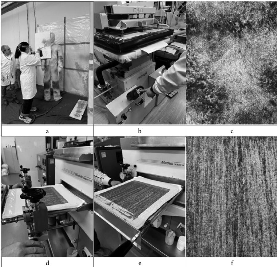
**Tabla 2.** Preparación del recubrimiento. Tabla 2. a) Aplicación de mezcla mediante aspersión; b) Resultado recubrimiento 1; c) Aspecto visual material 1; d) Aplicación de mezcla mediante técnica de cuchillo sobre rodillo; e) Prensado en plancha industrial; f) Aspecto visual material 2.
