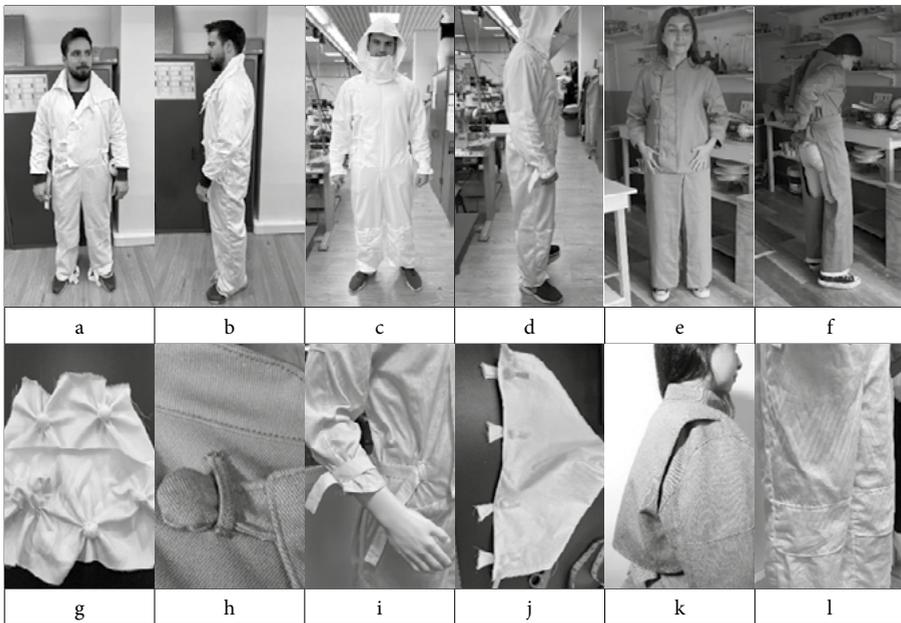
**Tabla 4.** *Prototipado modelo funcional.* Tabla 4. a) Prototipo 1, vista frontal; b) Prototipo 2, vista lateral; c) Prototipo 2, vista frontal; d) Prototipo 2, vista lateral; e) Prototipo 3, vista lateral; f) Prototipo 3, vista frontal; g) experimentación relleno monomaterial; h) experimentación botón monomaterial ; i) cintas ajustes; j) botones frontales; k) costuras de refuerzo; l) fuelles adaptables.
