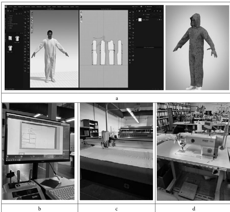
**Tabla 3. Prototipado.** Tabla 3. a) Software CLO 3D para modelado 3D y patronaje en 2D; b) Optimización de patrones / tela en software CLO 3D; c) Mesa de corte de telas Zünd G3; d) Máquina de coser recta industrial Pfaff 1183
