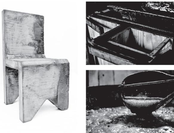
Figura 1. Cadeira Engenho e detalhes de sua confecção com o compensado naval
