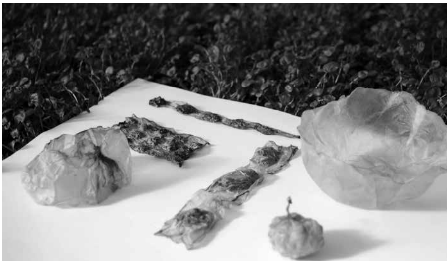
Fig.5. Bolsas elaboradas como contenedores comestibles o de uso orgánico. La diseñadora polaca Roza Janusz desarrolló Scoby, una alternativa a los envases de plástico para alimentos que está hecha por bacterias y se puede comer o compostar después de su uso. Gran parte de los residuos plásticos del mundo proviene de plástico de un solo uso, incluido el material de embalaje. El material de Janusz ofrece una alternativa que no ensucia, sino que enriquece el medio ambiente.
