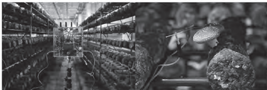
Figuras 6 y 7. Santiago Morilla (2025). MYCOTUNE v.1.0 . Fotografías del sintetizador y de sus electrodos conectados a los cultivos de shiitake de la empresa All Seasons Boletus S.L (Sant Quirze del Vallès) (Fuente: Foto cortesía de Santiago Morilla).
