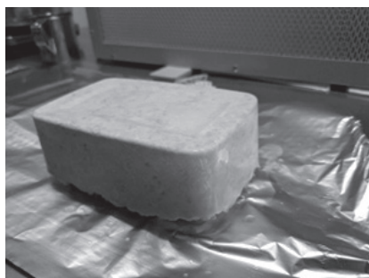
Figura 1. Brick de micelio perfectamente consolidado y desmoldado (Fuente: elaboración propia).
