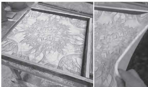
Figura 6. Molde de silicona obtenido a partir del relieve impreso en 3D, destinado a la producción de piezas y posteriores tratamientos superficiales (Fuente propia).
