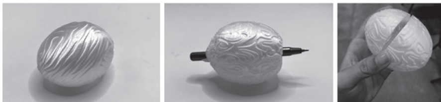
Figura 10. Estructura de fijación de objetos en la órtesis en forma de asterisco y prototipo en TPU flexible (Fuente: autores).
