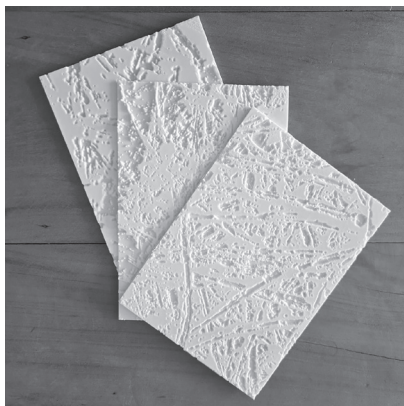
Figura 3. Matrices de poligrafía impresas en PLA (Fuente: Los autores, 2025).
