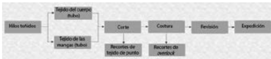
Figura 14 - Principales etapas de la confección de camisetas deportivas con zonas de ventilación utilizando la tecnología seamless (sin costura lateral). Fuente: Sanches et al. (2025)
