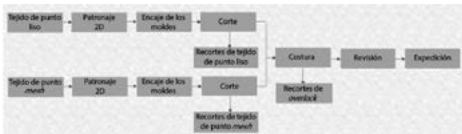
Figura 11 – Principales etapas de la confección de camisetas deportivas con zonas de ventilación. Fuente: Sanches et al. (2025)
