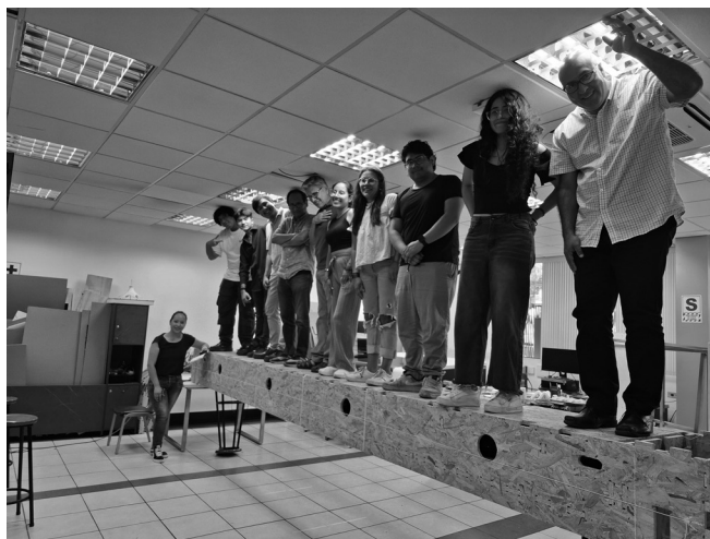
Figura 2. Evaluación de desplazamiento estructural de la viga prefabricada Floor M-1.
