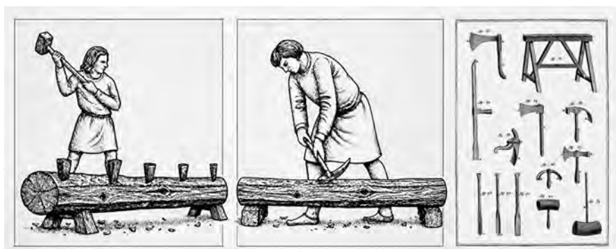
Figura 6. Proceso de hachado de madera mediante cuñas y alisado de viga con azuela - Herramientas para la construcción de estructuras de madera.
