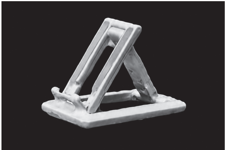
Figura 7. Modelo 3D reconstruido mediante MagicScan. Nota. Modelo 3D generado a través de fotogrametría móvil mediante MagicScan, utilizado para la evaluación de la geometría superficial y la calidad. Elaboración propia Gaibor, 2025.
