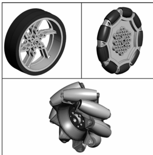
Figura 7. Diferentes modelos de ruedas de tracción intercambiables de uso posible. Fuente: Elaboración propia a partir de piezas estandarizadas GrabCAD de RevRobotics.
