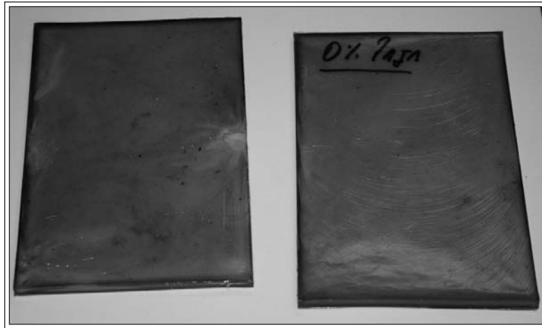
Figura 12. Placas elaboradas con PET de post consumo.
