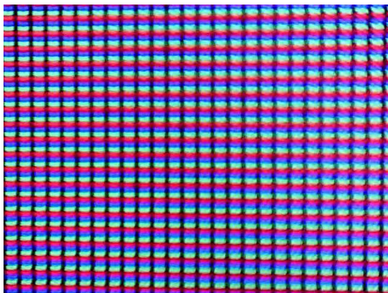
Ilustración 33 Píxeles de una pantalla vistos a través de un microscopio
